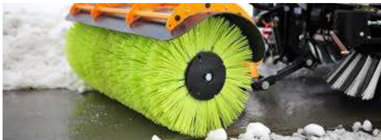
Рисунок 39 – Рабочая часть подметательной машины
