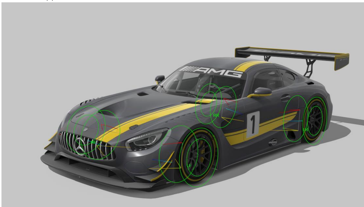
Рисунок 2.4.2.5.1 – геометрия подвески Mercedes AMG GT-3
