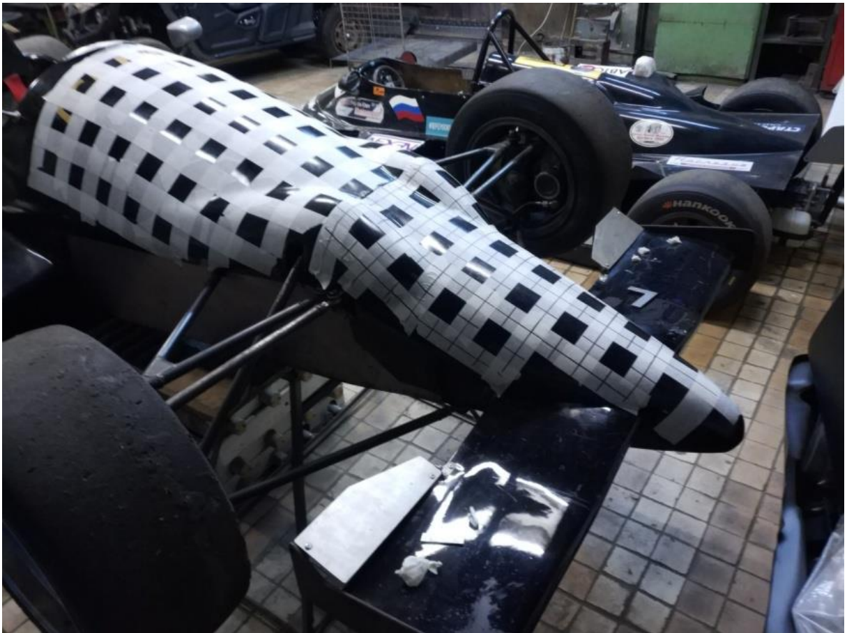
Рисунок 2.4.1 Полигональная сетка на носовом обтекателе, Эстония-25, класс 1600
