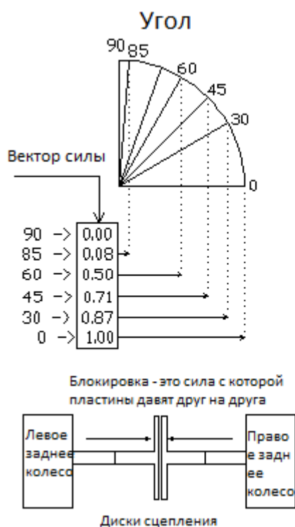
Рисунок 3.4.5.1. Углы шестерен блокировки.
