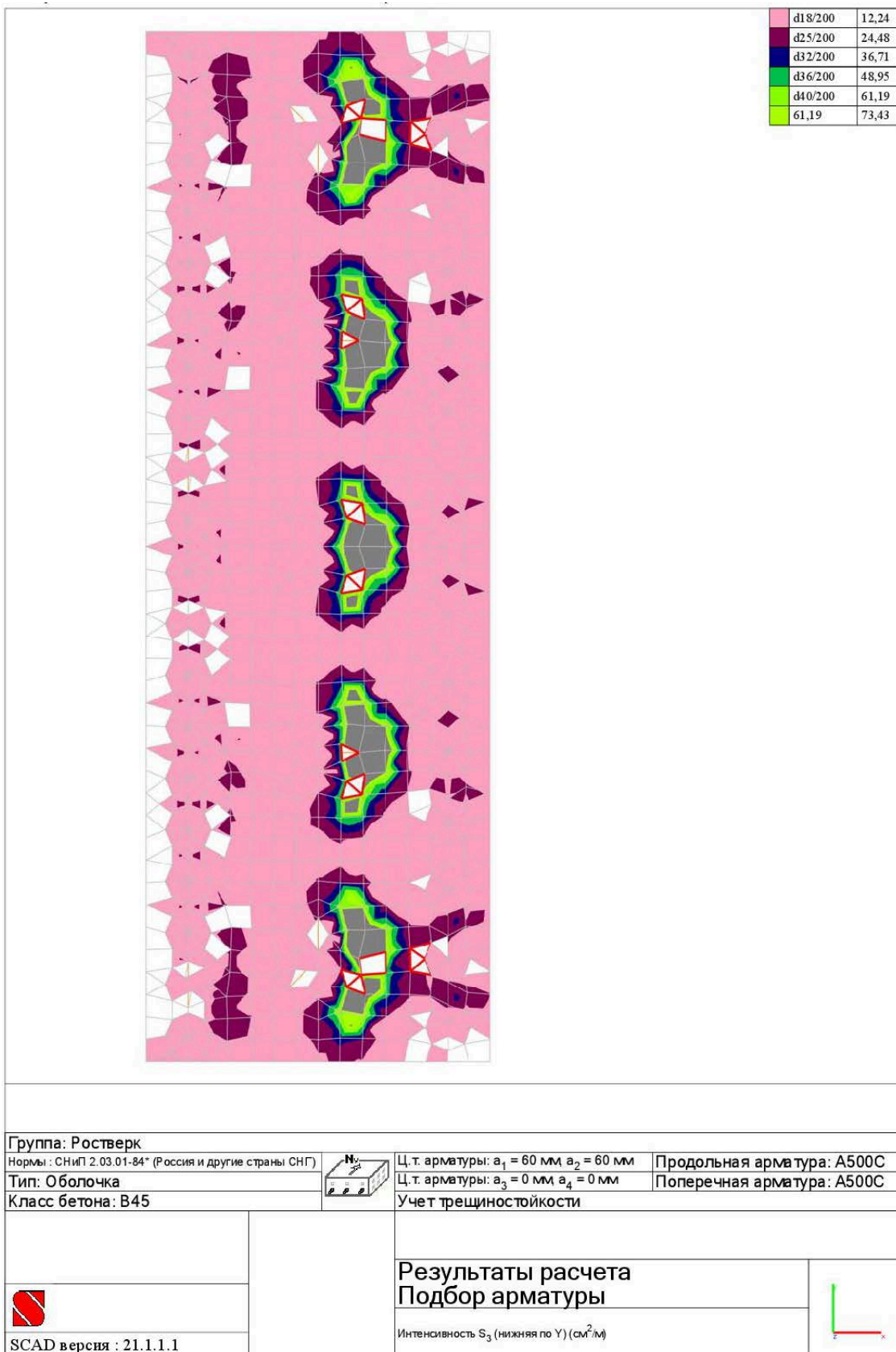
Рисунок 31 Нижнее армирование по Y
