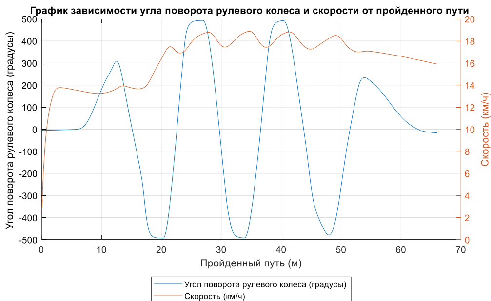
Рисунок 47. График зависимости угла поворота рулевого колеса и скорости от пройденного пути
