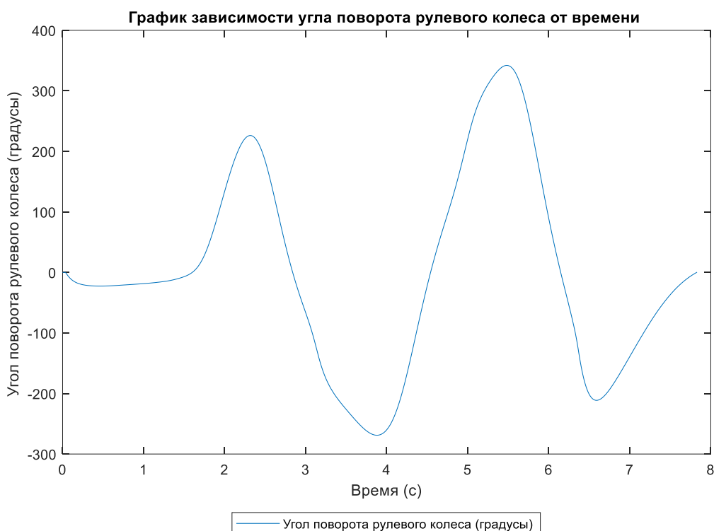
Рисунок 57. График зависимости угла поворота рулевого колеса от времени
