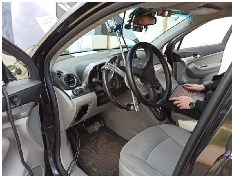
Рисунок 77. Измерительное рулевое колесо «MSW KISTLER»
