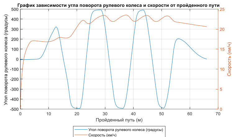
Рисунок 50. График зависимости угла поворота рулевого колеса и скорости от пройденного пути
