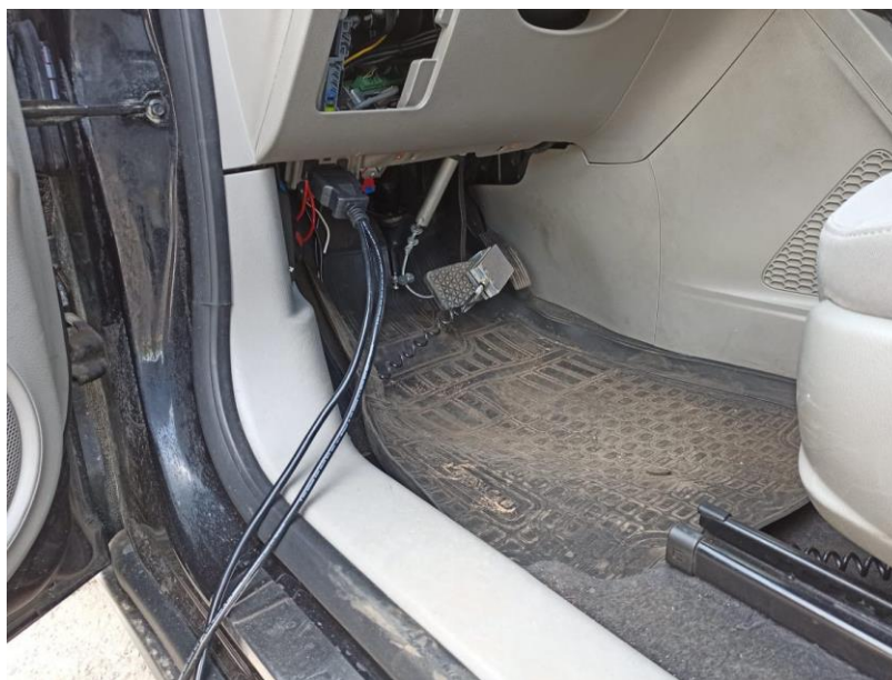
Рисунок 75. Датчик усилия нажатия на тормозную педаль
