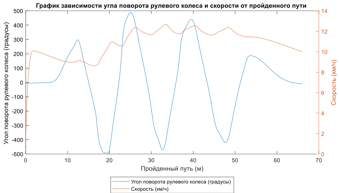
Рисунок 44. График зависимости угла поворота рулевого колеса и скорости от пройденного пути
