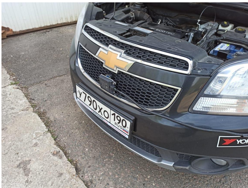
Рисунок 79. Сканирующее устройство лидар (LIDAR)
