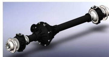
Сборная 3D модель переднего моста автомобиля УАЗ Патриот
