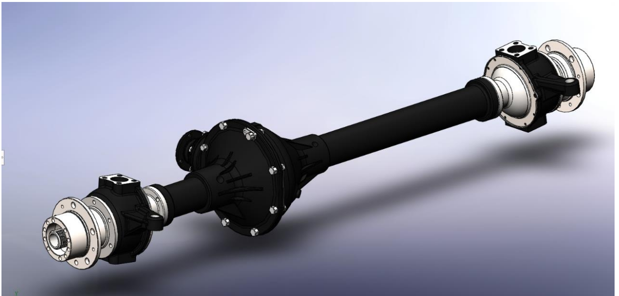
Рис. 1.8 Сборная 3D модель переднего моста автомобиля УАЗ Патриот
