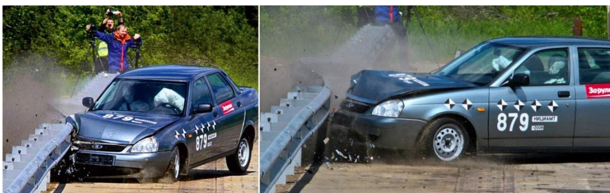
Рис. 4.8. Пример разворота автомобиля на испытаниях дорожных барьерных ограждений
