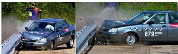
Разворот легкового автомобиля при натурных испытаниях дорожного барьерного ограждения
