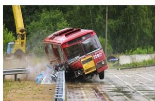
Опрокидывание автобуса при натурных испытания дорожного барьерного ограждения
