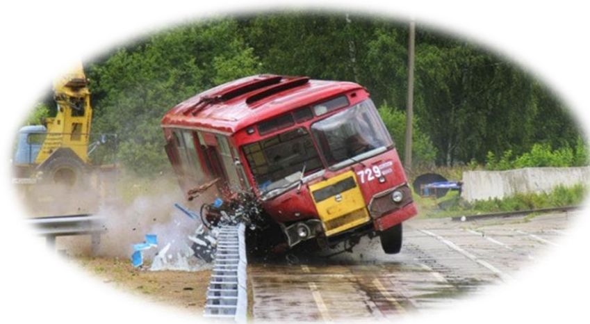
Рис. 4.9. Пример опрокидывания автобуса при проведении натуральных испытаний дорожного ограждения
