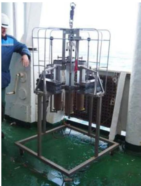
Рис. 3.2 Мультикорер KUM™, Германия (Отчет..., 2017)
