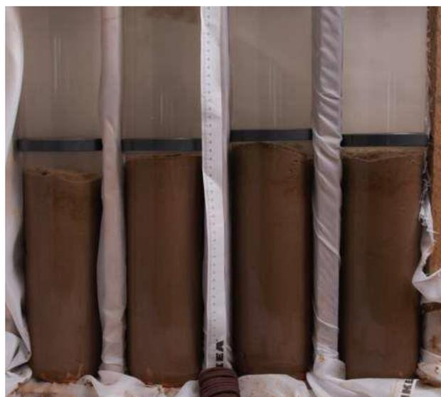
Рис. 3.3 Трубки мультикорера в судовой лаборатории (Отчет..., 2017)
