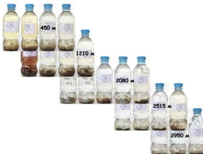
Рис. 3.7 Пробосборники седиментационных ловушек с осадочным веществом МСЛ-110
