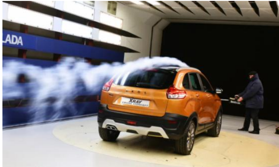
Рисунок 1.3 – Автомобиль в аэродинамической трубе
