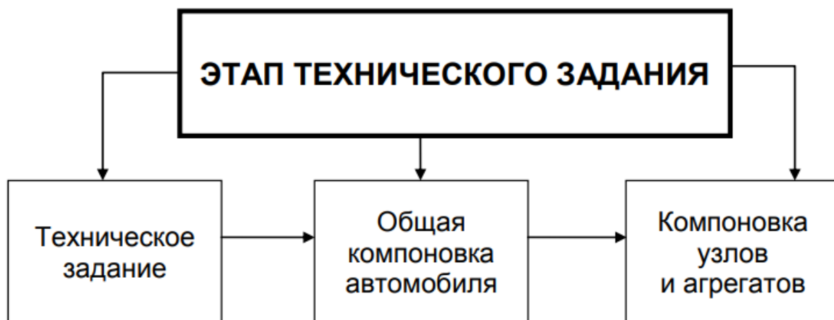
Рис. 16. Блок-схема этапа технического задания
