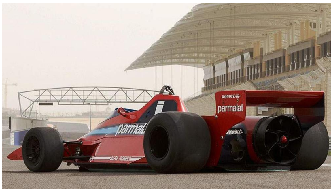
Рис. 5. Автомобиль Brabham BT46B (гоночный пылесос)
