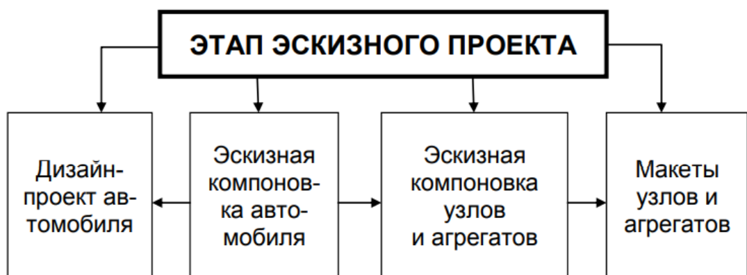
Рис. 11. Блок-схема этапа эскизного проекта
