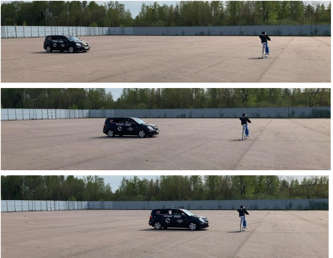
Рис. 3.5. Определение RCS макета велосипедиста при поперечном расположении
