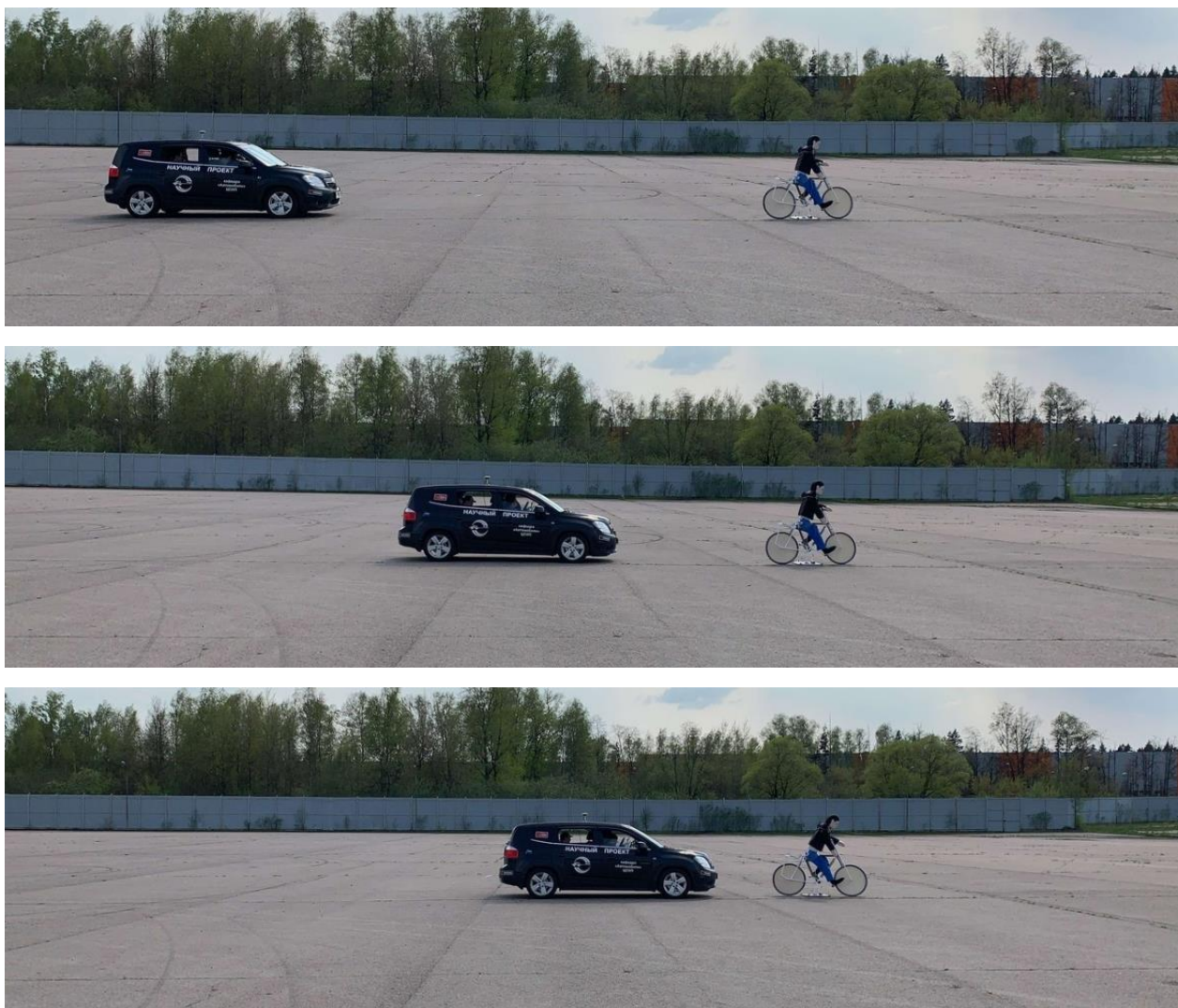
Рис. 3.6. Определение RCS макета велосипедиста при продольном расположении
