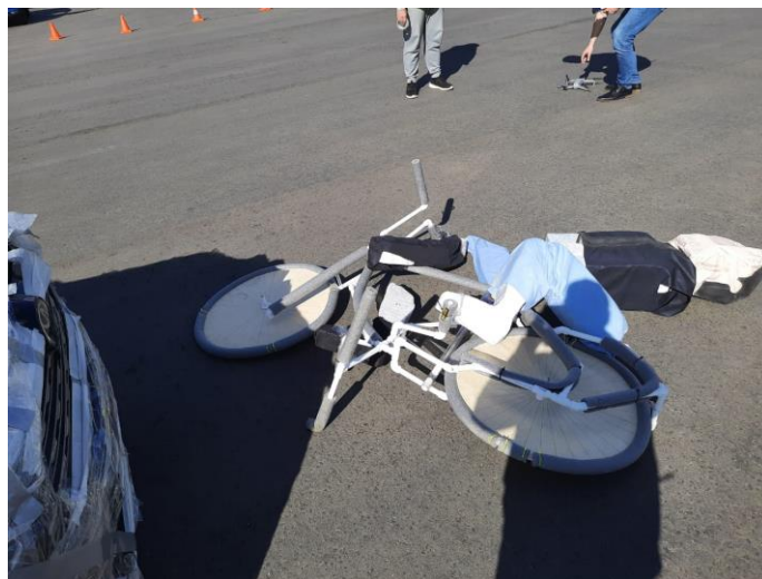
Рис. 4.15. Последствия столкновения макета с автомобилем
