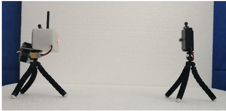
Рис. 2.9. Система запуска «Light-барьер»: 1 – фотоприемник с радиомодулем; 2 – источник света
