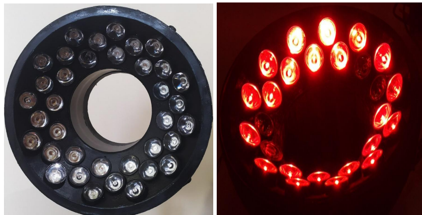
Рисунок 15. Изображение экспериментального светодиодного облучателя для ФДТ в конфигурации с 36 узкоспектральными светодиодами с длиной волны излучения 660 нм
