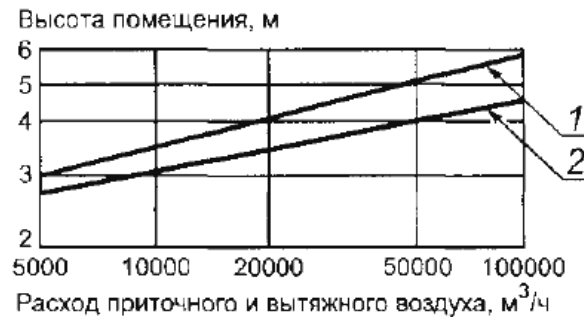
Рис. 4.4. 1- приточная система; 2 - вытяжная система
