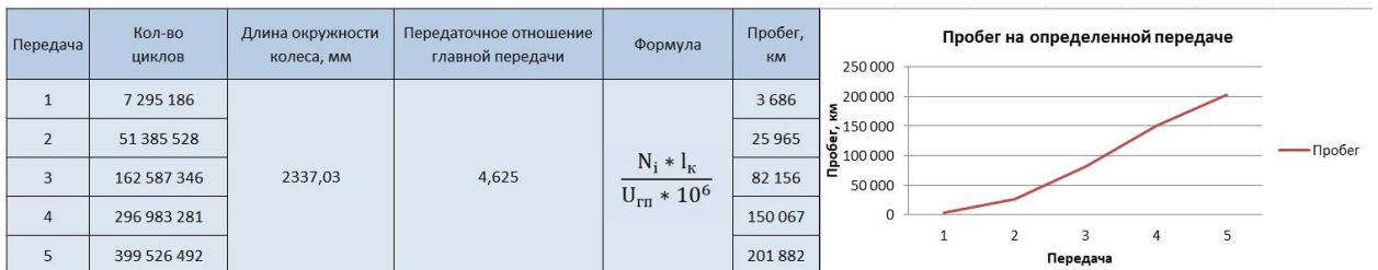
Рисунок 3.6.5 – Результат пересчета количества циклов в пробег, при использовании облегченной ведомой шестерни
