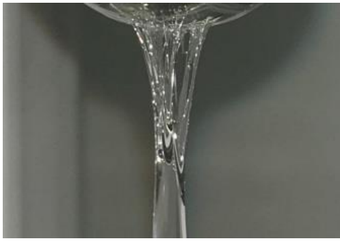
Рисунок 1 – Фотография мягкого материала ПДМС с характерными «нитями» адгезии при отделении от другого материала, здесь стекло (слева) и его химическая формула (справа)
