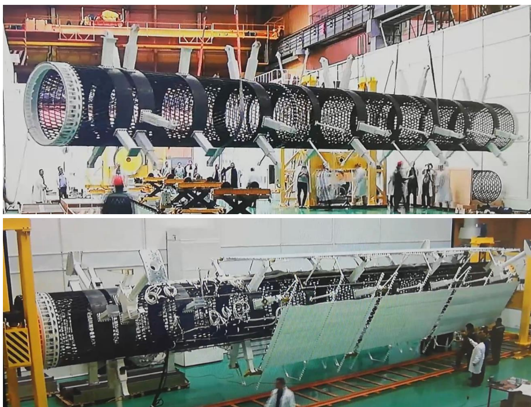
Рис. 1.3.2. Прототипы композитных сетчатых конструкций, входящих в состав системы отведения ЯЭУ от ПАО [29]
