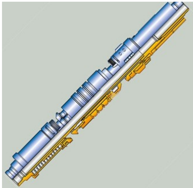
Рисунок 3- Схема механического пакера для скважины
