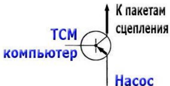
Рисунок 2.4 - Схема работы гидроблока
