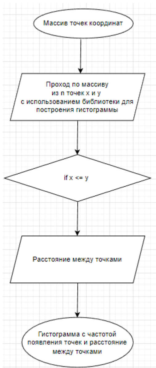
Рисунок 5 - Блок схема алгоритма построения гистограммы
