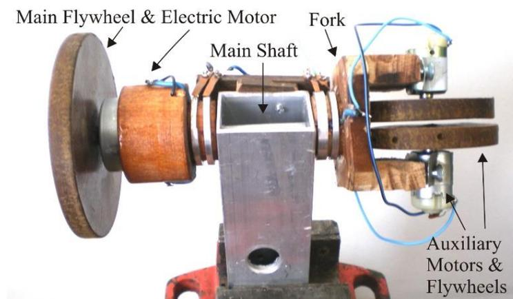
Рисунок 5. Экспериментальная установка эксперимента с двумя или тремя маховиками.
